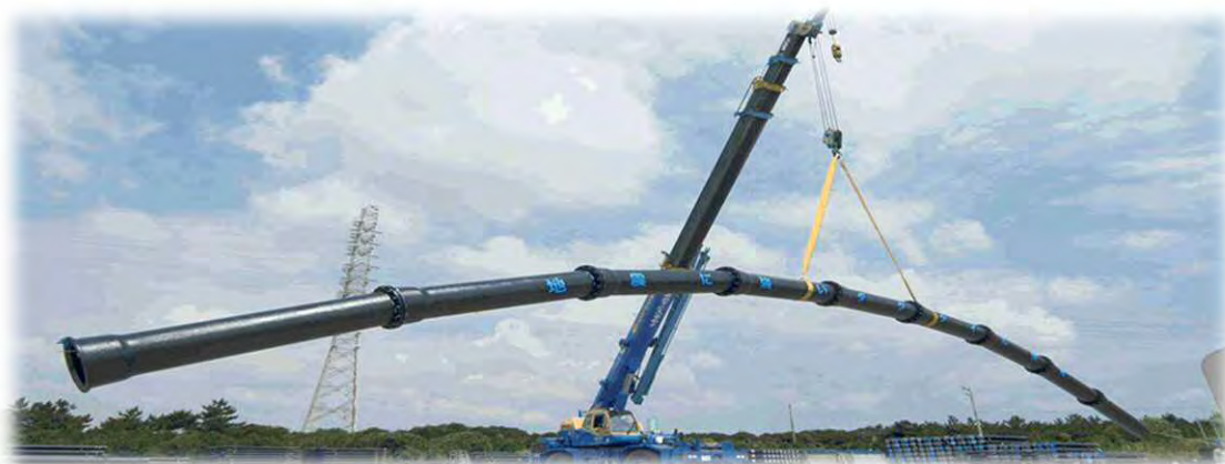
耐震型ダクタイル鋳鉄管（出典：ダクタイル鉄管協会 http://www.idpa.gr.jp/ ）
